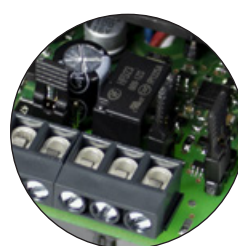
RELÉ KIMENET KIVÁLASZTÁSA N.C.-N.A. VAGY 8,2KΩ JUMPEREK HASZNÁLATÁVAL.
